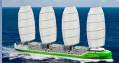
GARDINENSEGELN Bei Dynarigs rollen die Segel aus drehbaren Masten mit starren Rahen und bilden eine geschlossene Fläche. Das Handelsschiff »Ecoliner« ist noch in Planung. Die Megajacht »Black Pearl« (links) fährt bereits.
