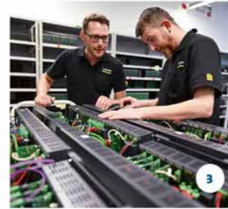
1 — Suzana Jovanović (rechts) bedient den Automaten, der elektronische Bauteile in die Platinen steckt. 3 — Thomas Wüstmer (links) und Reinhard Ruppert testen jede Steuerung 48 Stunden lang.
