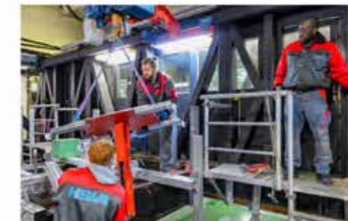
ATTRAPPE. Mit dem roten, 15 Zentimeter dicken Aluminiumrohr simuliert das HSVA-Team im Testaufbau einen Monopile.
