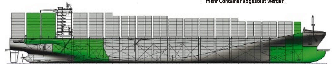
Die grün gefärbten Bauteile der »MSC Geneva« entstanden mit der Erweiterung. Auf den neuen Seitenbalkonen an Bug und Heck können nun mehr Container abgestellt werden.
